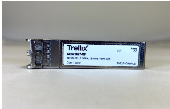
1310nm SFP+ transceiver module
